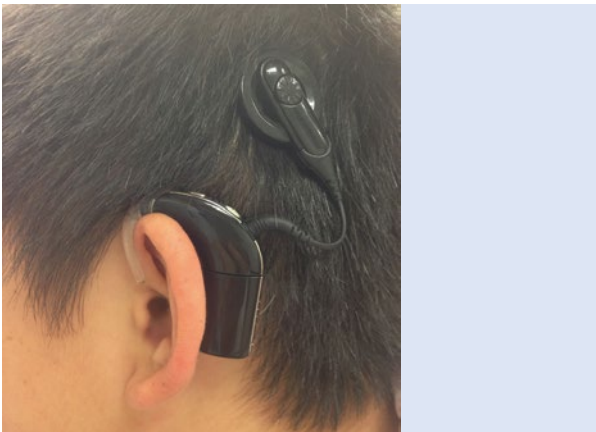
圖 1：人工電子耳外觀可見的體外機，包含有麥克風、言語處理機和傳送器。
