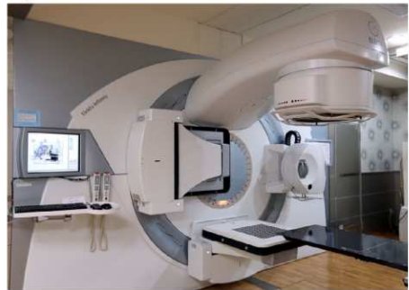
圖1、新式高功率直線加速器可使用 flattening filter free 模式給予弧形放射治療
